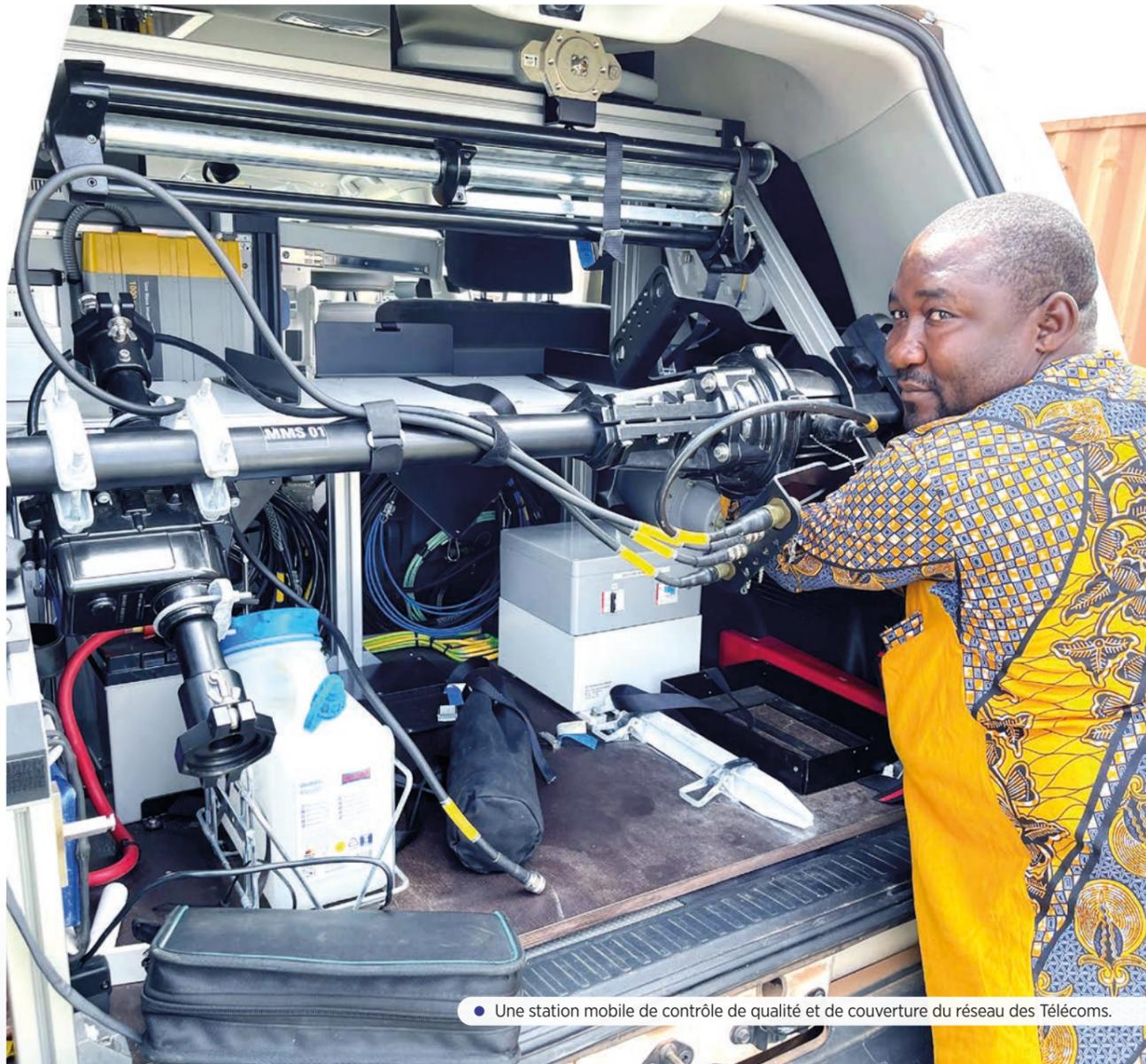
• Une station mobile de contrôle de qualité et de couverture du réseau des Télécoms.
